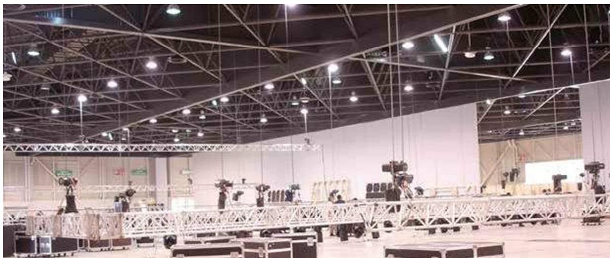
*Les nombreuses possibilités d'accroche scénographique du Palais des événements permettent l'implantation des enceintes, des vidéoprojecteurs, des écrans, etc. Dans le cas où des équipements doivent être suspendus au-dessus du gradin, il est nécessaire d'installer moteurs et poutres aluminium en amont du montage du gradin.*
